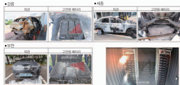
그림 1. 배터리 자연 발화로 인한 EV 및 ESS 배터리 화재사고 [출처: 한국일보(EV사고), 연합뉴스(ESS사고)]
