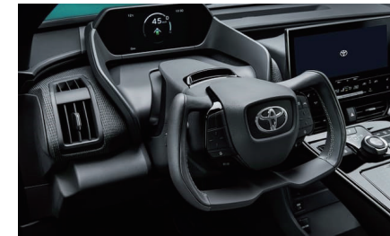
도요타 전기자동차 bZ4X 적용 Steer-by-Wire 시스템 (일본 JTEKT社)
